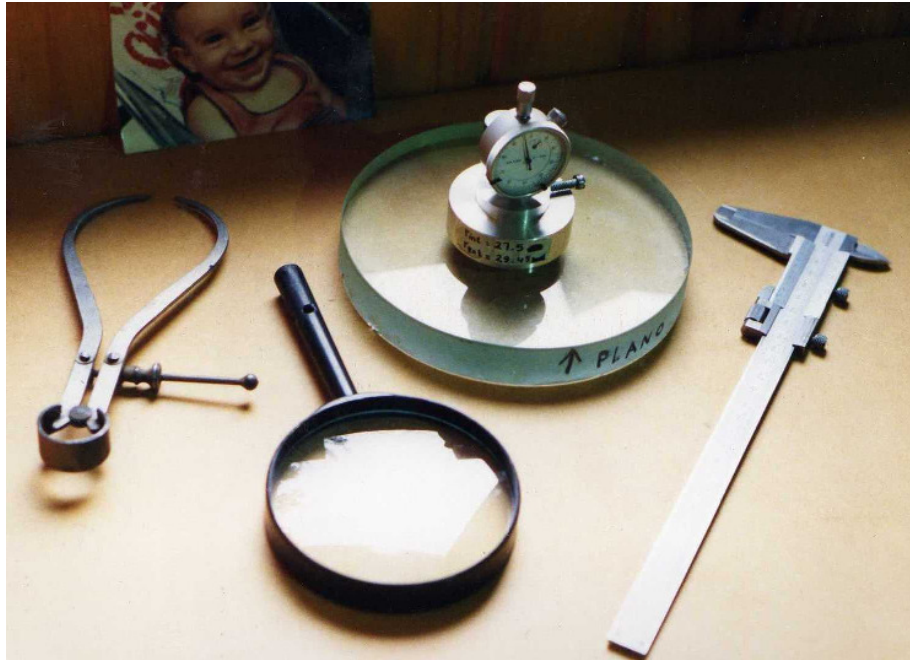
Fig 25. La lente y los elementos para definirla según la prescripción de abajo. A falta de un refractómetro se asumió que el vidrio es un BK7. (Sistema 2-lupach)
